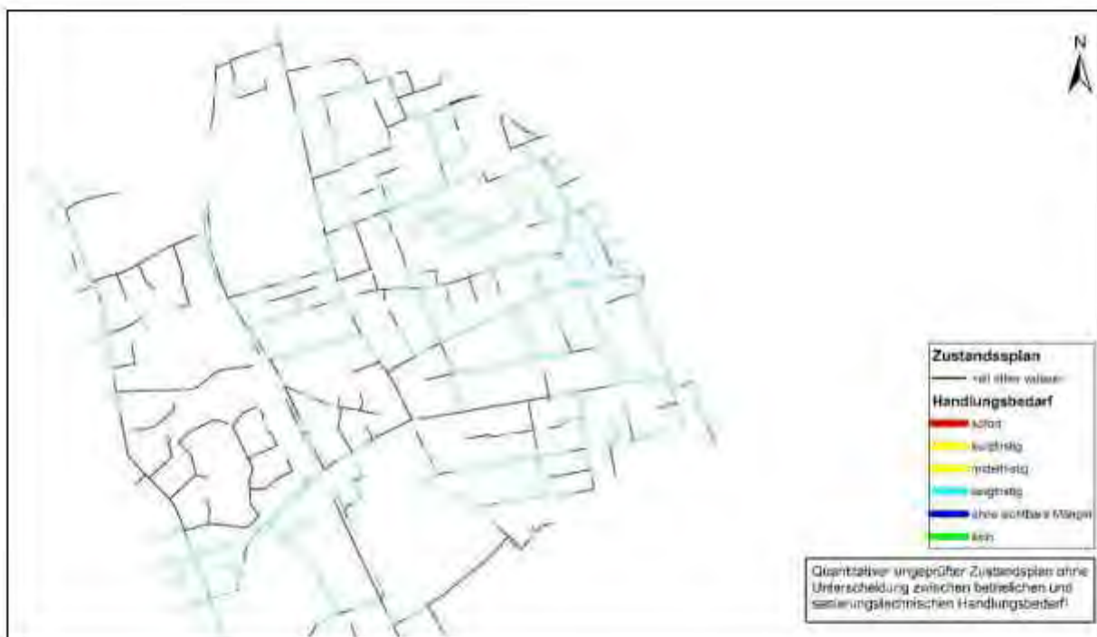
Abbildung 2-5: Zustand der öffentlichen Kanalisation im Siedlungsgebiet 2 (bewertet nach DWA-M 149 /38/)
