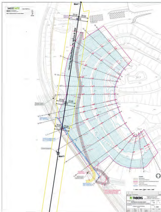
Bild 9.9 – Übererdungsbereich (hellblau) mit Darstellung Sicherheitsbereich Hochspannungsleitung
