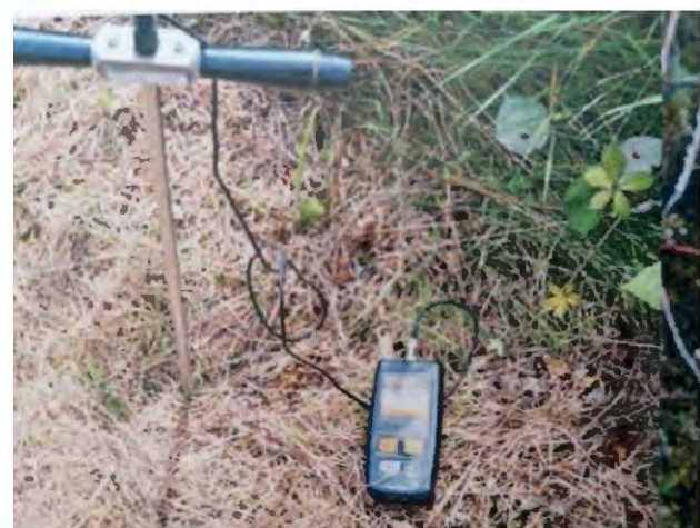
Bild 9.4 – Oberflächen-Temperaturmessung mit Stochsonde
