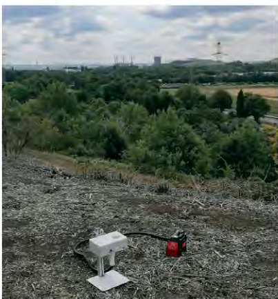
Bild 9.12a und 9.12b – „Elektronische Nase“ und Beispiel einer Datenaufzeichnung
