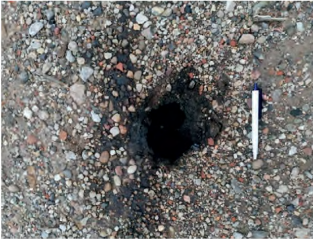
Bild 9.6 – Risse/Löcher in der Haldenoberfläche
