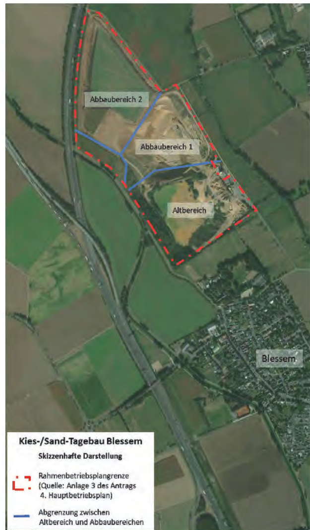
Bild 14.1 – Darstellung des Tagebaus Blessem (genehmigte Abbaugrenze (rot), Unterteilung in Altbereich und Abbaubereiche 1 u. 2 (blau)) (Quelle: Bericht des Ministeriums für Wirtschaft, Innovation, Digitalisierung und Energie des Landes Nordrhein-Westfalen vom 1. September 2021 an den Landtag Nordrhein-Westfalen (Vorlage 17/5646))
