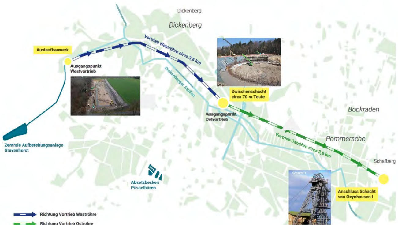
Bild 7.1 – Trassenverlauf Grubenwasserkanal Ibbenbüren (Quelle: RAG AG)
