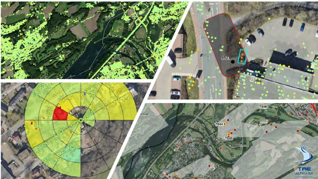
Bilder 12.2 – Ergebnisse des radarinterferometrischen Monitorings mittels SqueeSAR® im Rahmen des Monitorings im Risikomanagement Altbergbau. Für bekannte Tagesbruchbereiche (unten links) sowie Tagesöffnungen und deren Gefährdungsbereiche (oben rechts) erfolgten Verschneidungsanalysen (Kartenhintergrund: ESRI World Imagery).
